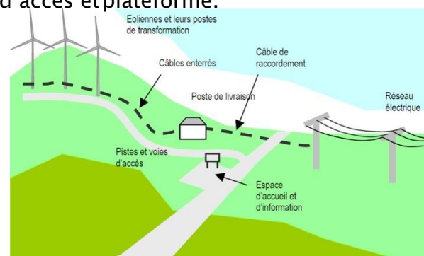
Schéma descriptif d'un parc éolien terrestre
